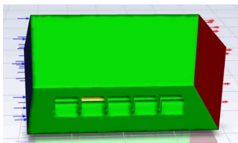
Fig. 5 - Modelarea fluxului de aer introdus și evacuat
