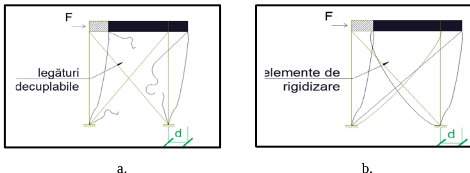
Fig.10. Schema unui sistem: a. cu legături decuplabile; b. cu elemente de rigidizare
