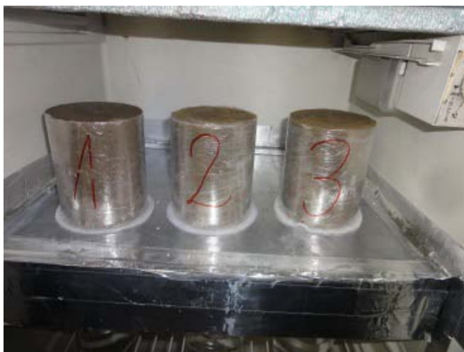
Fig. 3. Cilindrii confectionați din pământ stabilizat cu Dorosol [1]
