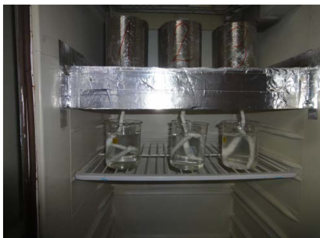
Fig. 2. Poziționarea cilindrilor din pământ stabilizat cu Dorosol [1] în frigider
