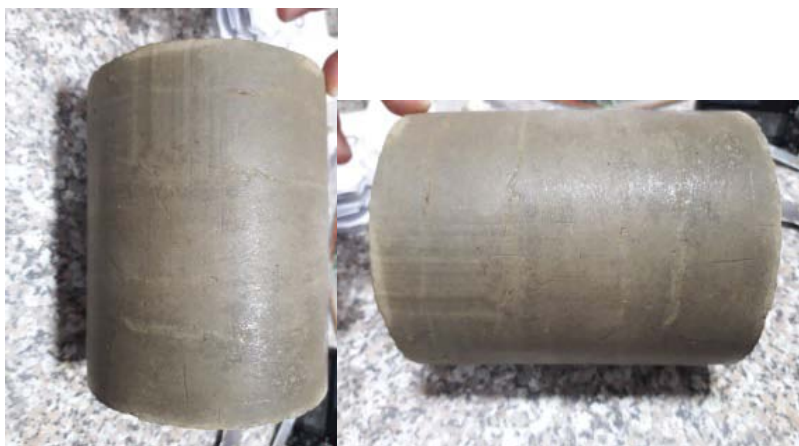
Fig. 4. Cilindru din pământ stabilizat cu Dorosol [1] după efectuarea testului
