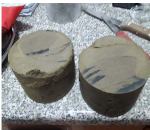
Fig. 5. Cilindru din pământ stabilizat cu Dorosol [1] secționat după testare
