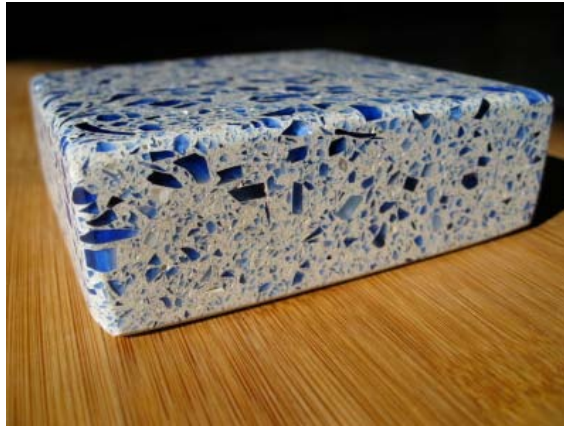
Fig. 1 Beton cu agregat din sticlă [18]
