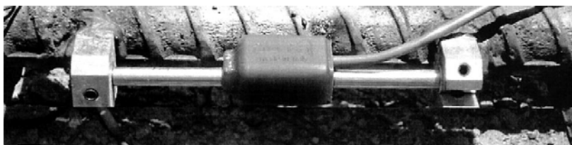
Fig.2. Tensometru montat pe armătură
