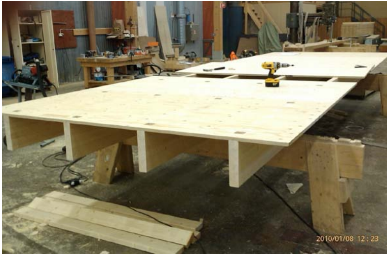
Fig.3. Producerea și asamblarea componentei de lemn-Parcul de producție Setra [Nežerka Václav]
