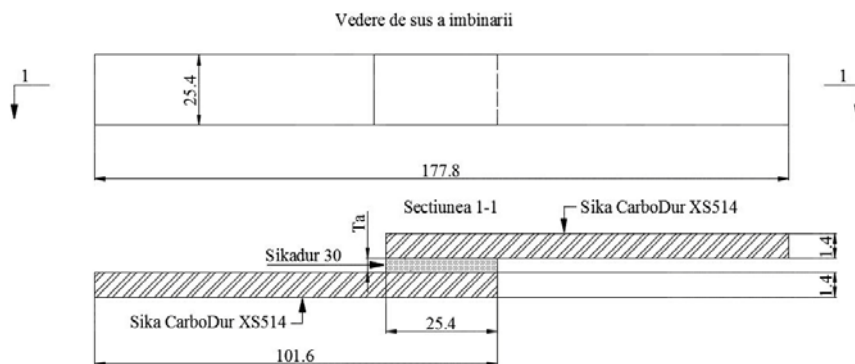
Fig. 1. Caracteristicile geometrice ale îmbinării [mm].
