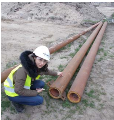
Fig.8. Ansamblu de tuburi utilizate pentru prelevarea probelor în stare proaspătă prin carotare
