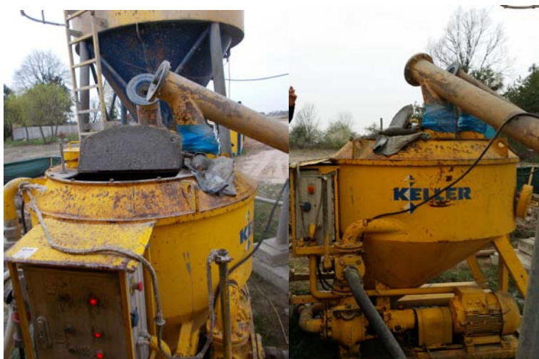
Fig.2. Malaxor utilizat pentru pregătirea suspensiei de ciment
