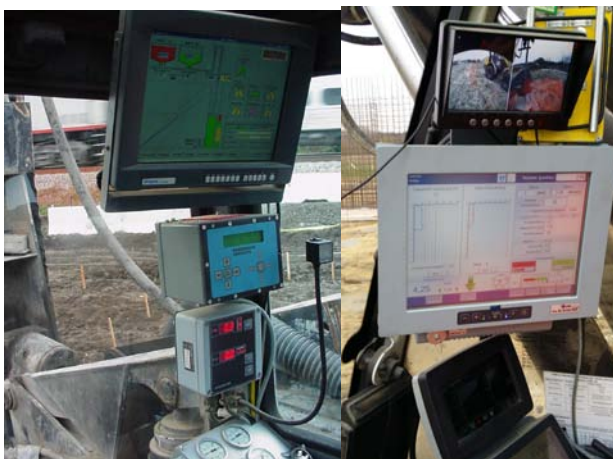
Fig.5. Cabina operatorului - dispozitive de afișare și de ajustare a parametrilor de execuție
