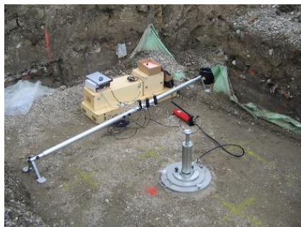
Fig. 2. Încercarea cu placa
