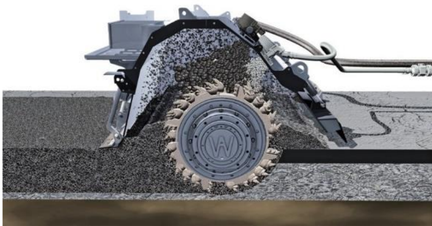
Fig. 1. Stabilizarea materialului recuperat odată cu frezarea și măcinarea acestuia [4]
