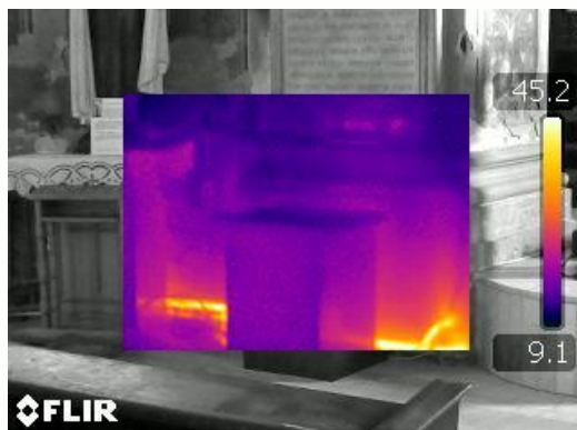
Fig.2. Degradările surprinse în imagini cu termoviziune redau zonele cu punți termice ce favorizează apariția condensului
