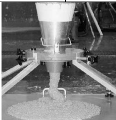
Fig. 2 Testul cu pâlnia V
