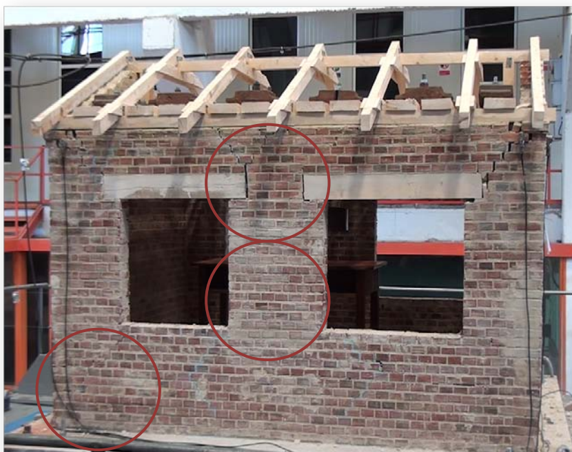
Fig. 13 Captură preluată din timpul testării modelului pe platforma seismică
