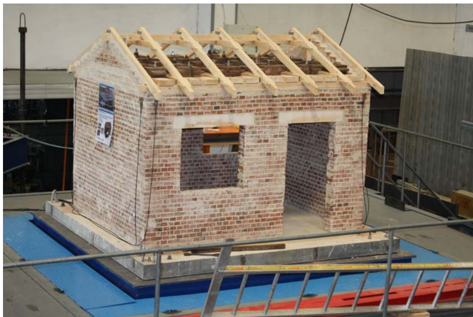
Fig. 1 Modelul experimental montat pe platforma seismică
