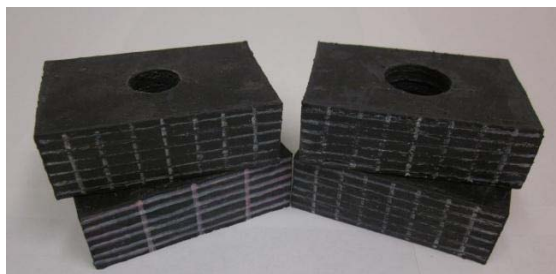
Fig. 7. Reazem din elastomer armat cu fibre (Van Engelen, N. C., și alții, 2012)
