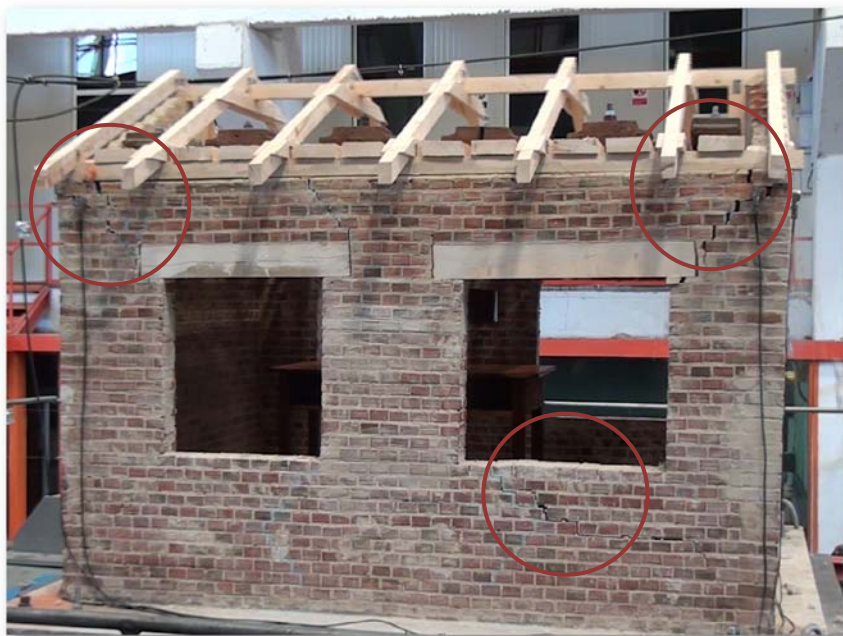
Fig. 11 Captură preluată din perioada testării pe platforma seismic a modelului
