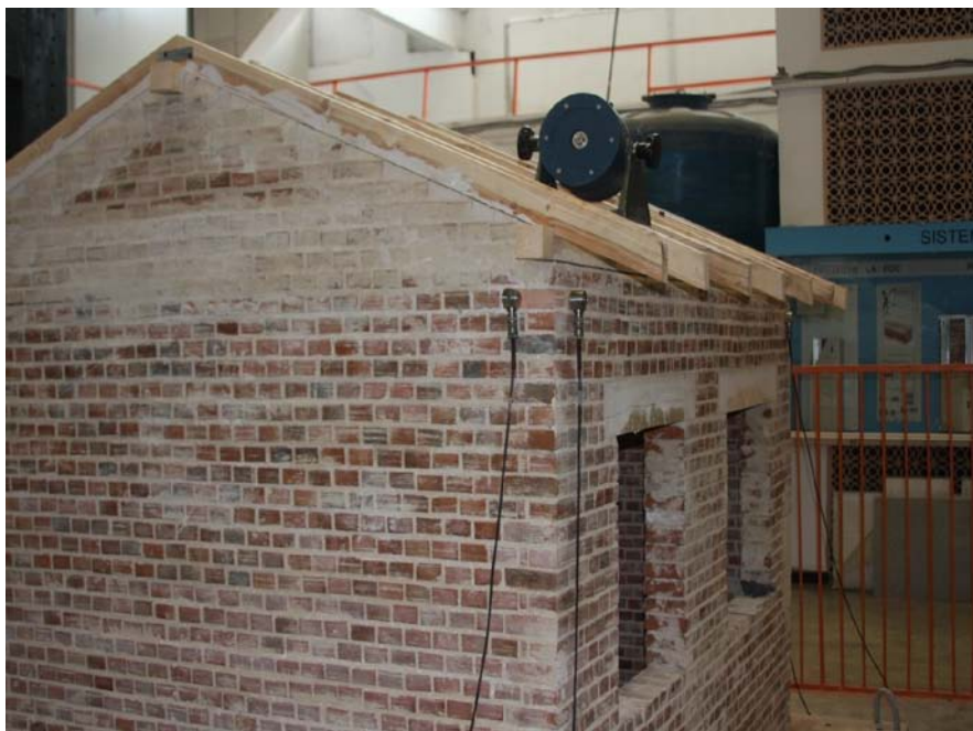
Fig. 5 Montarea generatorului de vibrații și a accelerometrelor pentru etapa de evaluare a caracteristicilor dinamice
